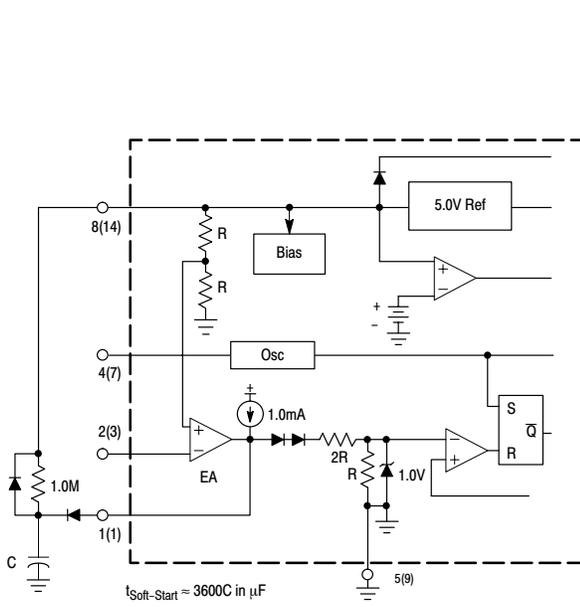
Figure 24. Soft-Start Circuit
