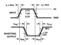
FIGURE 3. HCT TRANSITION TIMES AND PROPAGATION DELAY TIMES, COMBINATION LOGIC
